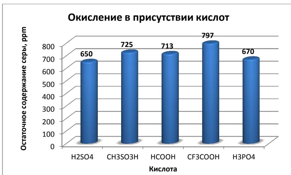
Рисунок 39. Окисление в присутствии кислот в присутствии и отсутствии металла. Условия реакции: 2 ч, 20°C, соотношение H<sub>2</sub>O<sub>2</sub>:S:Mo = 800:200:1 по молям, соотношение кислота:S=1:1 по молям, исходное содержание серы – 2000 ppm
