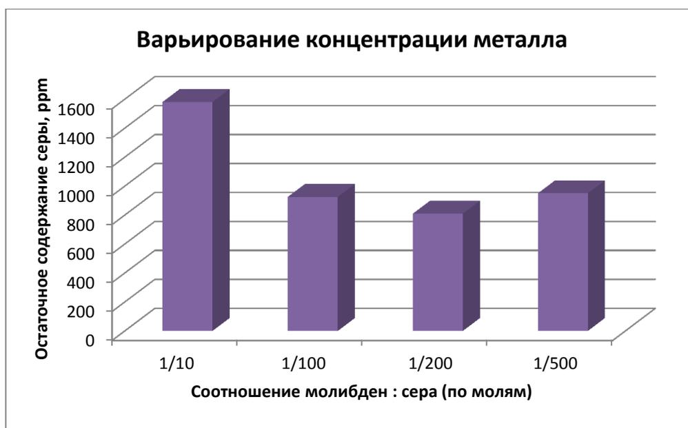
Рисунок 38. Влияние концентрации катализатора на глубину протекания обессеривания. Условия реакции: 2 ч, 20°C, соотношение  $\text{H}_2\text{O}_2:\text{S} = 4:1$  по молям, исходное содержание серы – 2000 ppm
