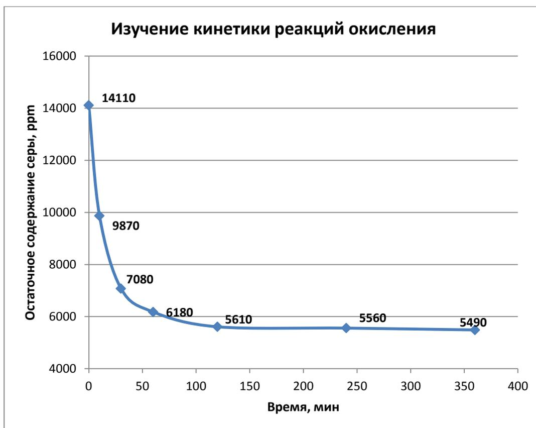
Рисунок 45. Влияние времени реакции окисления на глубину обессеривания газового конденсата. Исходное содержание серы – 14110 ppm. Условия реакции: температура 20 °С, соотношение  $Mo : S : H_2O_2 = 1:200:400$  по молям. Экстракция продуктов окисления сернистых соединений ДМФА (объемное соотношение топливо: экстрагент = 1:1)
