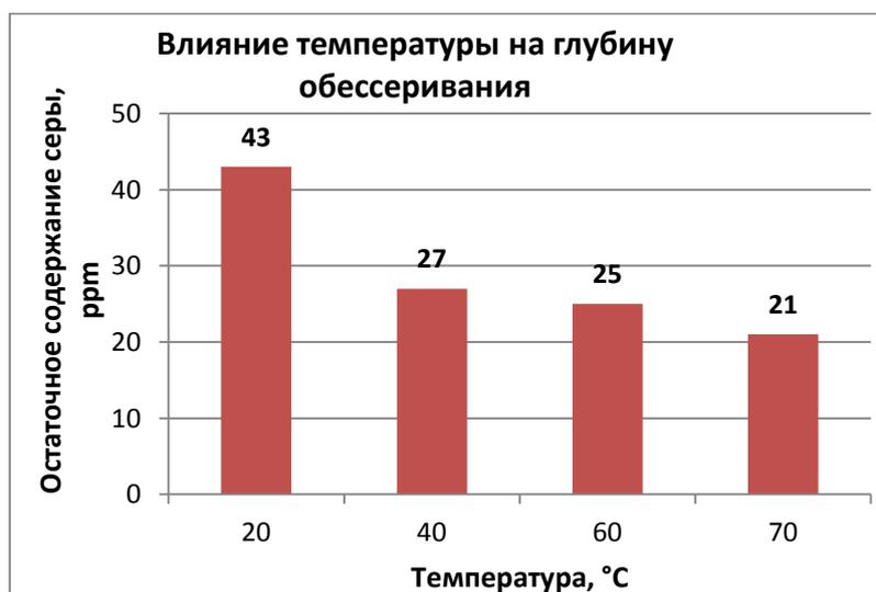
Рисунок 25. Влияние температуры на глубину обессеривания прямогонной бензиновой фракции. Условия реакции: 2 ч, соотношение  $H_2O_2:S:Mo:H_2SO_4 = 800:200:1:200$  по молям, исходное содержание серы – 700 ppm
