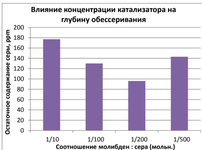
Рисунок 21. Влияние концентрации катализатора на глубину протекания обессеривания. Условия реакции: 2 ч, 20°C, соотношение  $H_2O_2:S = 4:1$  по молям, исходное содержание серы – 700 ppm
