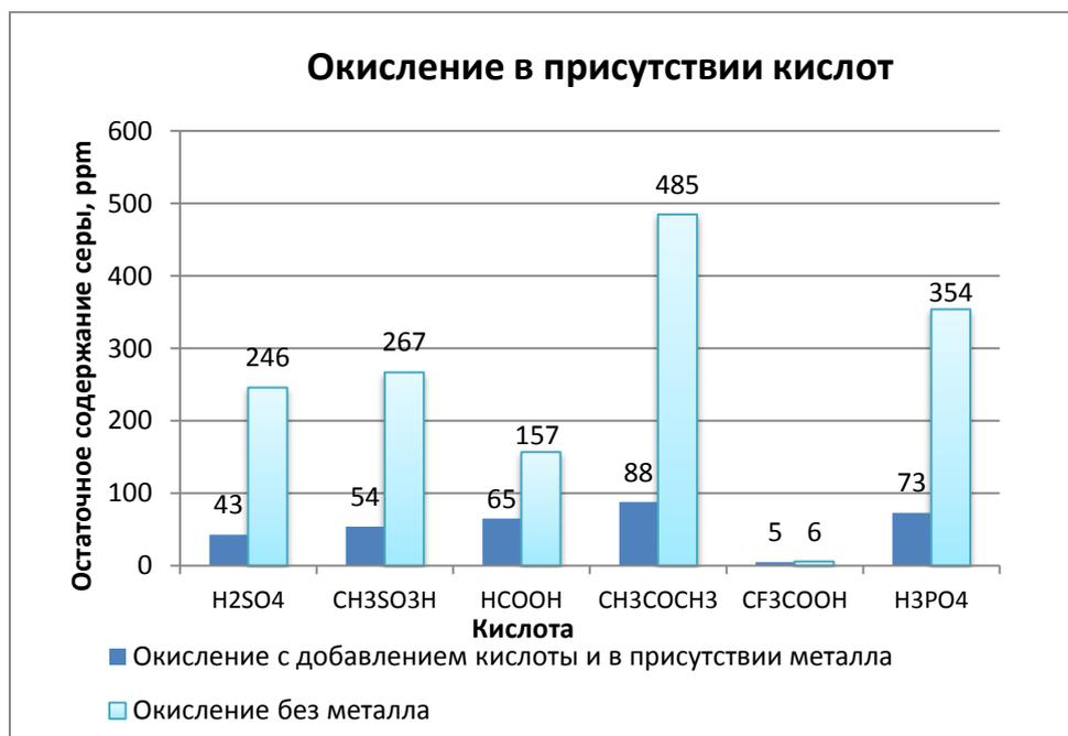
Рисунок 24. Окисление в присутствии кислот с добавлением металла и без металла. Условия реакции: 2 ч, 20°C, соотношение H<sub>2</sub>O<sub>2</sub>:S:Mo = 800:200:1 по молям, соотношение кислота:S=1:1 по молям, исходное содержание серы – 700 ppm
