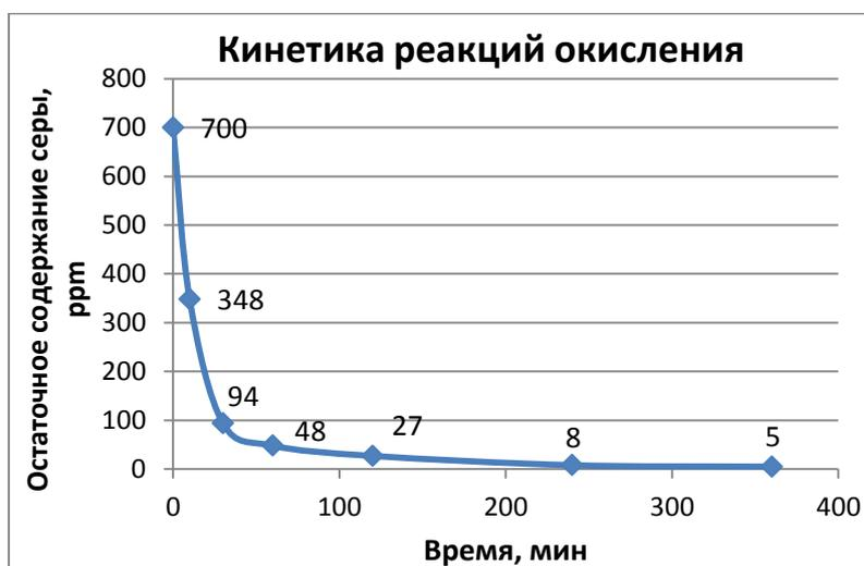
Рисунок 26. Влияние времени реакции окисления на глубину обессеривания прямогонной бензиновой фракции. Условия реакции: температура 40 °С, соотношение  $H_2O_2:S:Mo:H_2SO_4 = 800:200:1:200$  по молям, исходное содержание серы – 700 ppm
