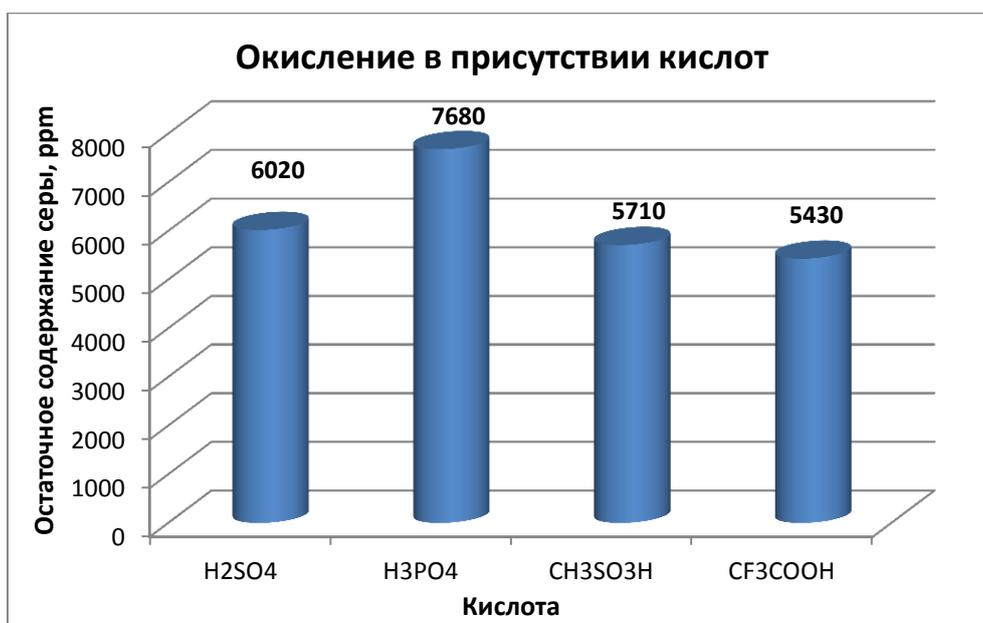
Рисунок 44. Окисление сернистых соединений в присутствии кислот. Исходное содержание серы – 14110 ppm. Условия реакции, 2 ч 20°C, мольное соотношение Mo : S : H<sub>2</sub>O<sub>2</sub> : кислота = 1:200:400:200. Экстракция продуктов окисления сернистых соединений ДМФА (объемное соотношение топливо: экстрагент = 1:1)
