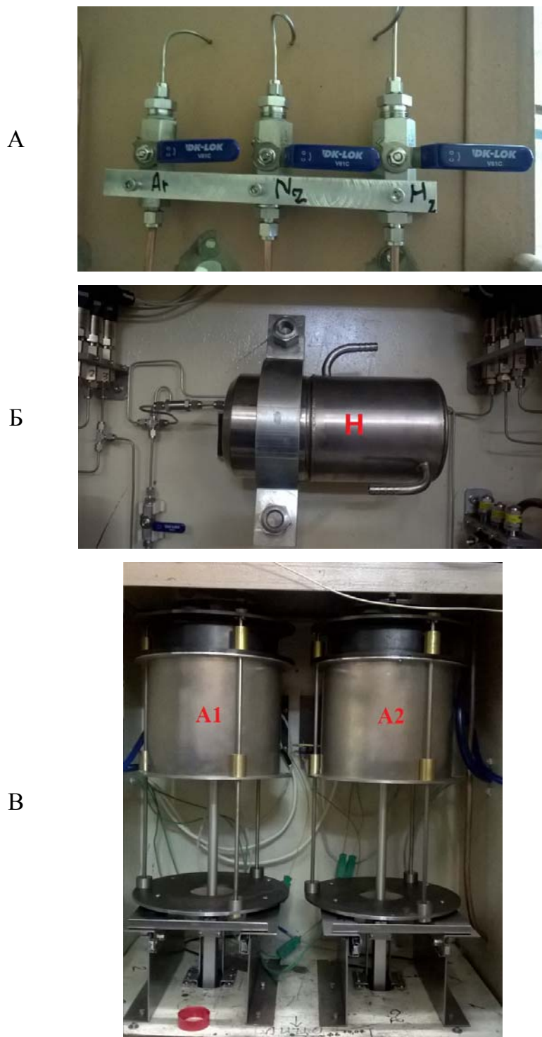
Рис. 2. Некоторые элементы термогазобарической системы: А) вентили для подачи газов в систему; Б) аккумулятор водорода; В) реакторы, помещенные в печи.
