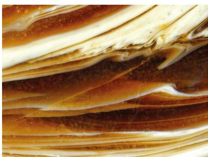
Увеличение вводимых в стекломассу количеств угля и серы до 2% и 0.7% соответственно приводит к кристаллизации сульфида цинка в стекле уже в процессе варки. Такое стекло при выработке его на лист или в стальную бочку получается «полосатым».
