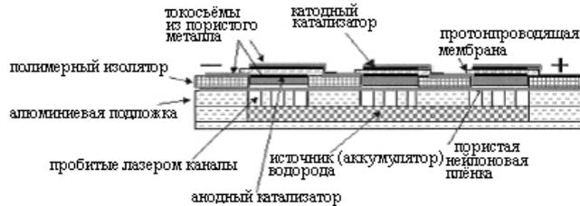
Рис. 7. Батарея ТЭ, интегрированная с аккумулятором водорода
