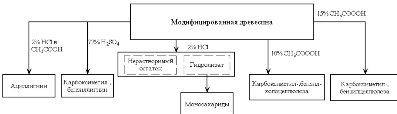
Рис. 2. Схема выделения компонентов из модифицированной древесины
