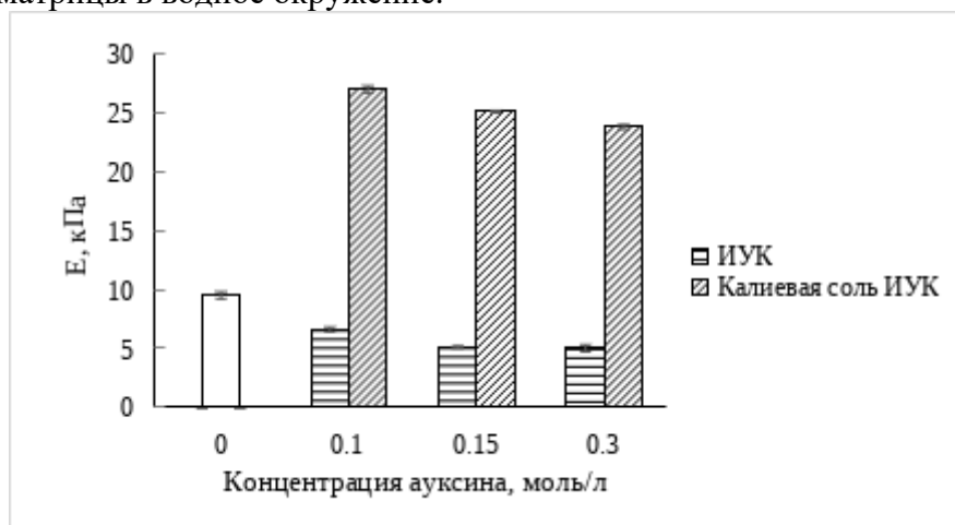
Рисунок - График зависимости модуля Юнга при одноосном сжатии (E) образцов КГПВС от концентрации внесённой добавки индолил-3-уксусной кислоты (ИУК) и калиевой соли ИУК
