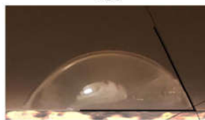
Угол смачивания водой < 90 °
