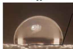
Угол смачивания водой > 90 °
