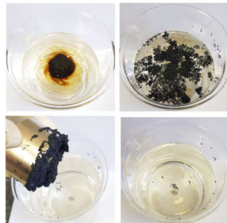
Сорбция нефти с поверхности воды и удаление сорбента с помощью магнита
