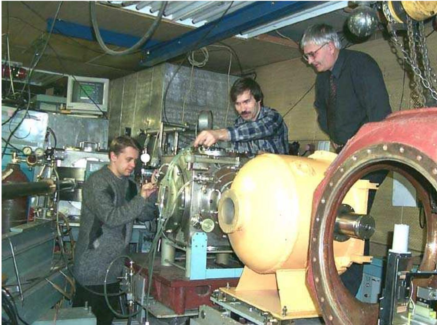
**Рис. 1.**Монтаж новой экспериментальной станции "Взрыв-1", предназначенной для исследования детонационных процессов при мощности взрыва до 50 г тротилового эквивалента.
