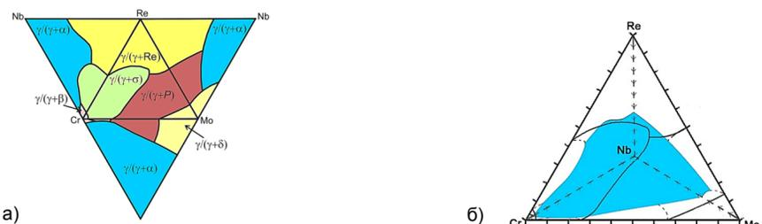
Рисунок 2. Графическое представление проекции поверхности никелевого твердого раствора в пятикомпонентной системе Ni-Re-Nb-Cr-Mo при 1375 К на тетраэдр составов, выраженных в относительных концентрациях легирующих компонентов: а) развертка тетраэдра, б) тетраэдр с выделенной границей  $\gamma/(\gamma+\alpha)$ .
