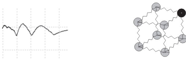
Рис. 15. Тепловые движения атомов в кристаллической решетке
