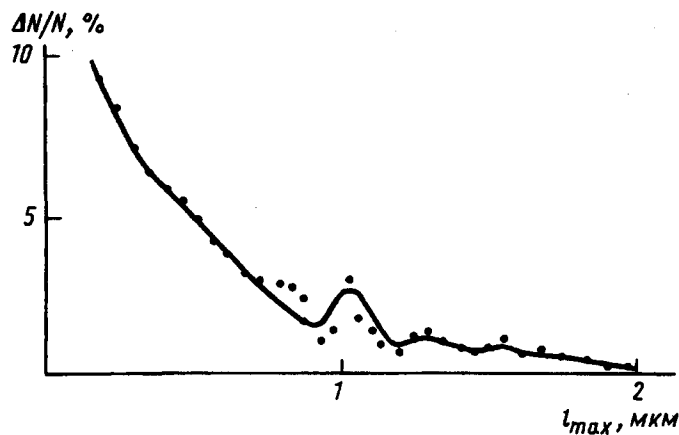
Рис. 3. Зависимость максимального размера частиц гидразона, сформировавшихся на поверхности кристаллов гидразида, от доли частиц гидразона данного размера
