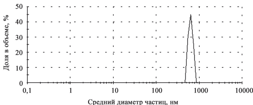
Рис. 4. Распределение по размеру наночастиц с интерфероном (Ифн-Алг-Са)-Хит, полученных ионотропным гелеобразованием с использованием из альгината низкой вязкости и хитозана с молекулярной массой 150 кДа
