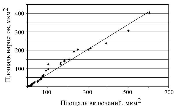
Рис. 4. Зависимость площади нароста на грани (100) от площади проекции ближайшего включения на эту грань
