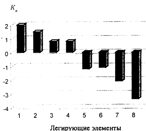
Рис. 5. Коэффициенты ликвации легирующих элементов Ta (1), Al (2), Cr (3), Mo (4), Ru (5), Co (6), W (7), Re(8) при кристаллизации монокристаллов из высокоренивеного жаропрочного никелевого сплава
