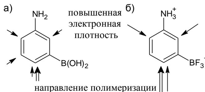
**Рисунок 27.** 3-аминофенилборная кислота (а) в исходном состоянии и (б) в присутствии избытка фторид-ионов.
