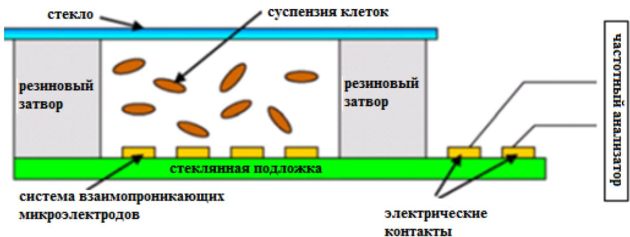
**Рисунок 13.** Импедиметрический сенсор для определения бактериальных клеток в деионизованной воде.
