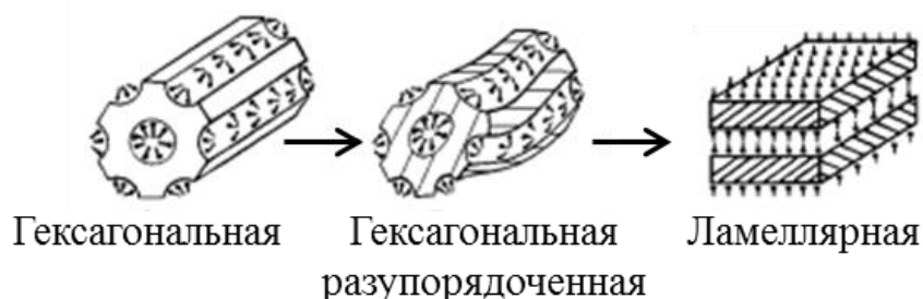
Рисунок 30 – Схематическая модель структурной трансформации образца ZSM-5/MCM-41 в процессе перекристаллизации. \square – аморфная фаза, /// – кристаллическая фаза [95]
