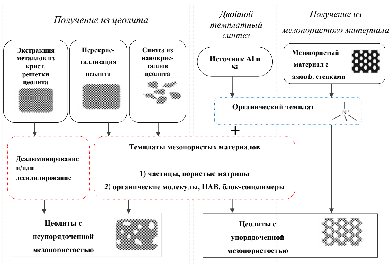
Рисунок 11 – Схема синтеза цеолитных структур с упорядоченной и неупорядоченной мезопористостью [7]
