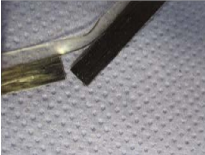
Рис. 59. Излом образца композиционного материала «УВ+полиуретан» после его изгиба на 90°.
