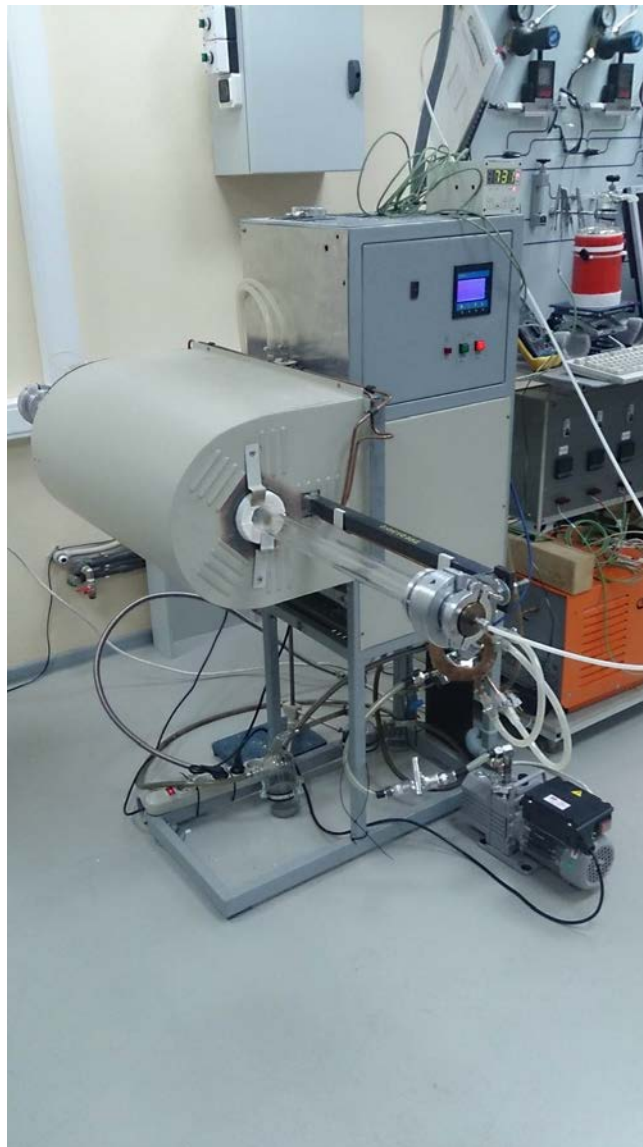
Рис. 39. Установка для получения УНТ с проточным кварцевым CVD-реактором.
