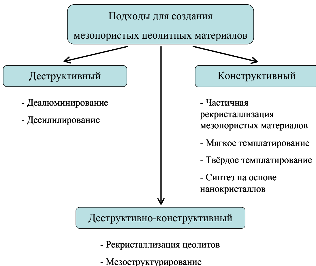
Рисунок 1.1 – Схематическое изображение подходов для создания материалов с микро-мезопористой структурой на основе цеолитов
