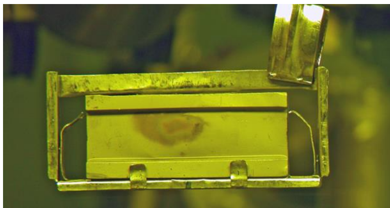
Рис. 20. Облученная ториевая мишень в графитовой оболочке.
