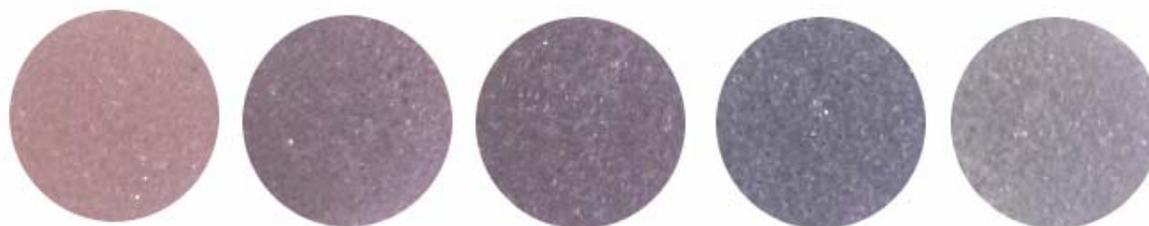
Рис. 55. Тест-шкала для определения ПГМГ с помощью ППУ и наночастиц золота. c_{НЧ} = 15 МКГ/МЛ, V = 5 МЛ, c_{ЭДТА} = 0,01 М.
