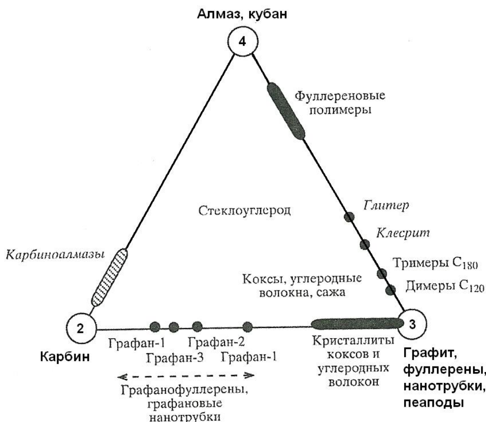
Рис. 1.5. Схема структурной классификации углеродных материалов по количеству соседних атомов в первой координационной сфере или по соотношению атомов, образующих в материале 2, 3 или 4 ковалентные связи (курсив – гипотетические структуры) [37].
