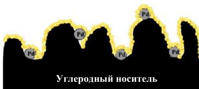
Рисунок 2.7 – Pd-содержащий катализатор на основе ИЖ, нанесенной на углеродный носитель [30]
