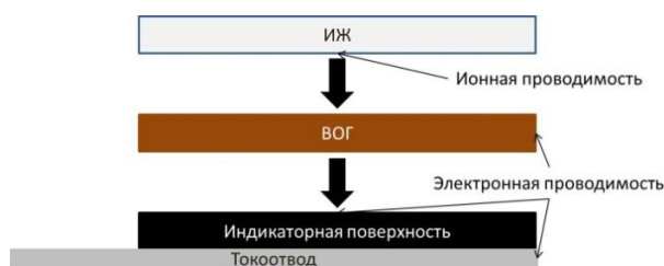
Рис. 35. Схема строения твердотельного электрода
