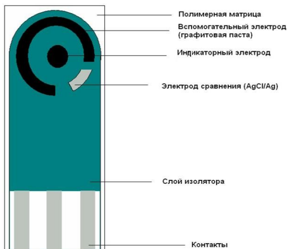
Рис. 11. Конструкция твердотельного планарного электрода
