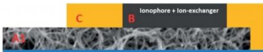
Рис. 7. Строение сенсора: А1 – слой КГ-графена (нанотрубок) с ПВХ, В – ионочувствительная мембрана, С – слой изолятора.
