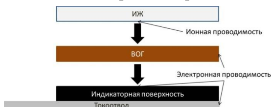
Рис. 7. Схема строения твердотельного электрода с использованием ВОГ
