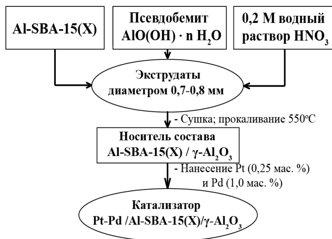
Рисунок 3 – Схема приготовления Pt-Pd катализаторов на основе Al-SBA-15(X)
