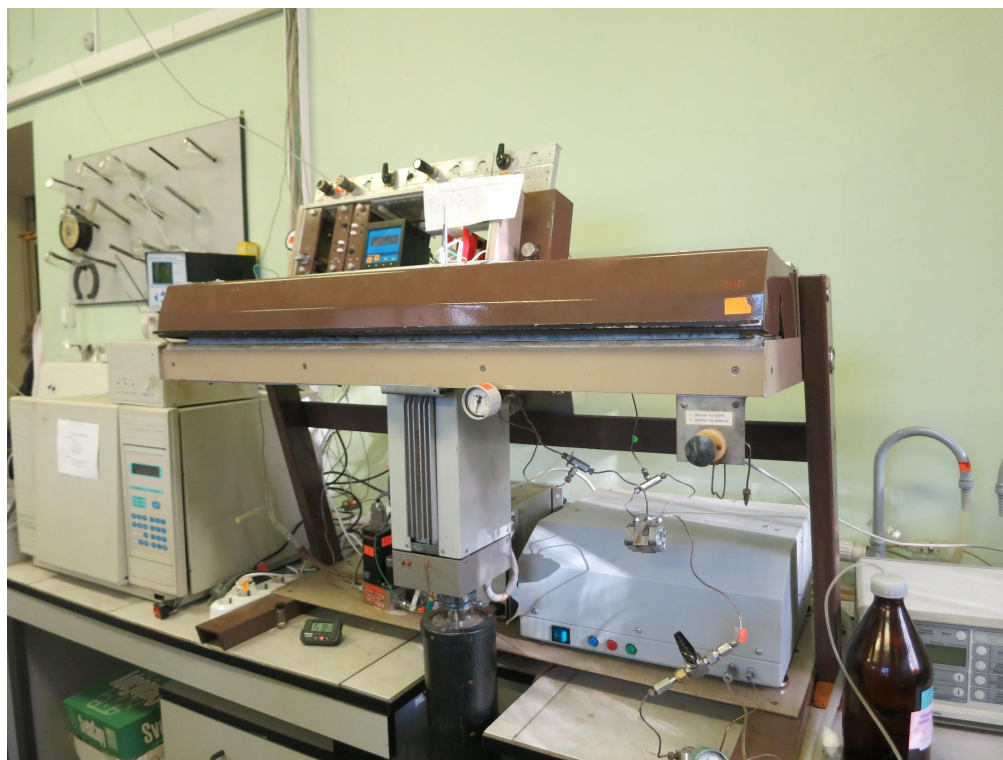
Рисунок 3.1 – Схема (а) и внешний вид (б) проточной каталитической установки для проведения реакции
