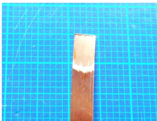
Рисунок 32 – Фотография медного образца после электрополирования в ИЖ-1 (2,8 Кл)
