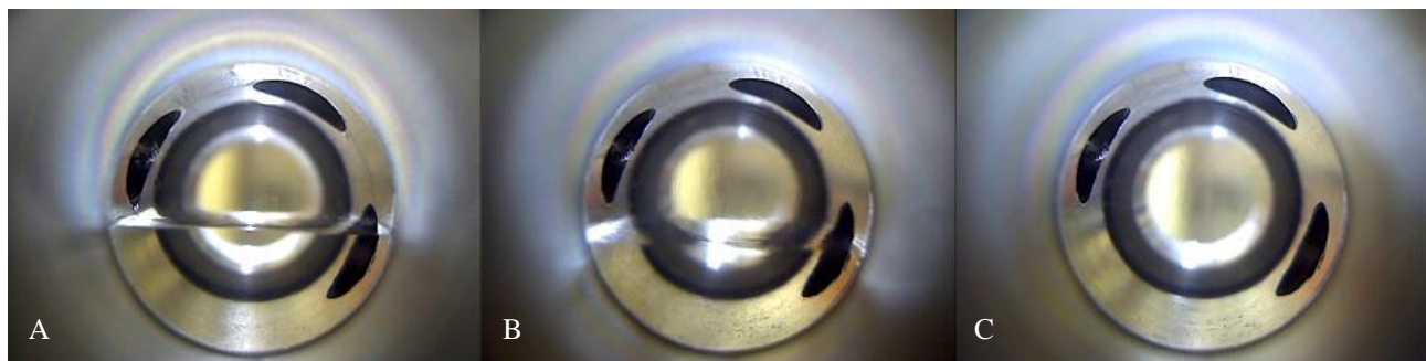
Рис. 26. Нагревание \text{CHF}_3 в закрытой ячейке постоянного объема. Т 22 °C (А), Т 26 °C (В) и Т 30 °C (С).
