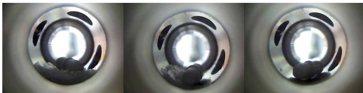
Рис. 59. Ячейка с DL-лактидом, полностью заполненная жидким \text{CHF}_3 при комнатной температуре.
