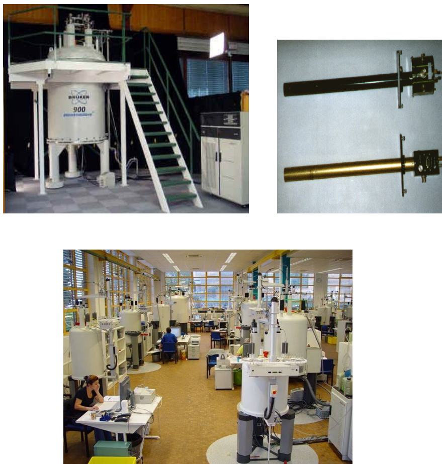
Рис. 2.18. Спектрометр AVANCE-900 фирмы «Брукер» с соленоидом на 21,06 Т и измерительные датчики к нему (вверху). Вид современной лаборатории ЯМР с несколькими спектрометрами в крупном научном центре (внизу).
