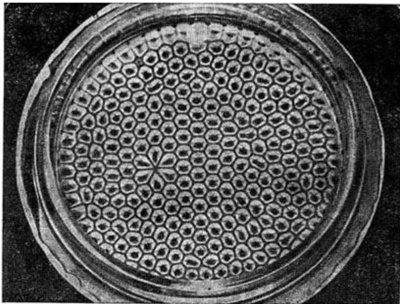
Самоорганизация жидкостей. Силиконовое масло равномерно подогревается снизу. В присутствии алюминиевого порошка на верхней поверхности, соприкасающейся с воздухом, можно наблюдать конвекционные ячейки Бенара (по *Nicolis G., Dewel G., Turner J. W.*, *Order and Fluctuations in Equilibrium and Nonequilibrium Statistical Mechanics*, с разрешения John Wiley and Sons, Inc.: снимок предоставлен E. L. Koschmieder).
