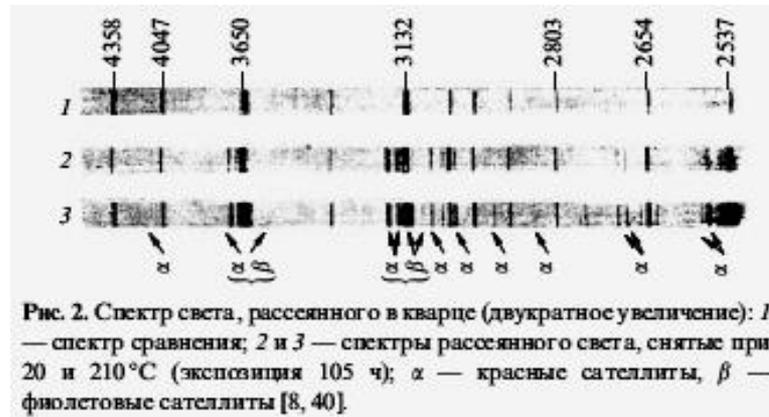
Рис. 2. Спектр света, рассеянного в кварце (двукратное увеличение): 1 — спектр сравнения; 2 и 3 — спектры рассеянного света, снятые при 20 и 210°C (экспозиция 105 ч);  $\alpha$  — красные сателлиты,  $\beta$  — фиолетовые сателлиты [8, 40].
