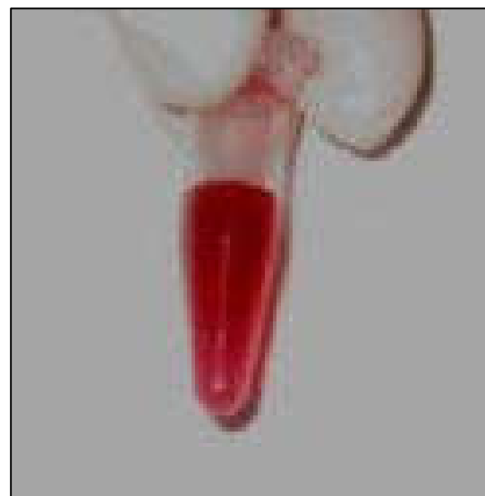
Наночастицы золота, размером 11 нм, полученные по методу Туркевича
