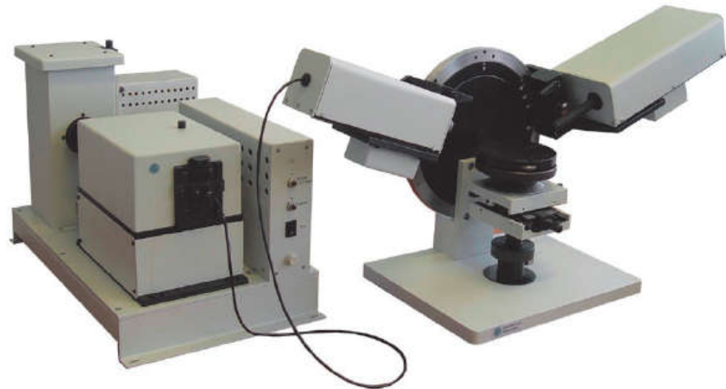
РИСУНОК 3 | Внешний вид спектрального эллипсометра: он состоит из блока осветителя и измерительного блока, соединенных оптоволоконном
