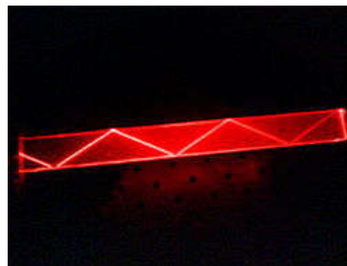
Полное внутреннее отражение в блоке ПММА
