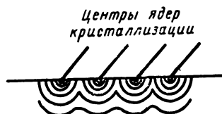
Рис. 14.3. Рост поверхности раздела фаз в топохимической реакции
