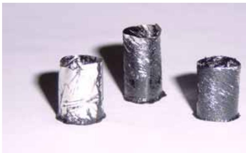
Самопроизвольное текстурирование висмут-содержащих ВТСП на поверхности серебряных цилиндров. Левый цилиндр не имел искусственного рельефа и не покрыт слоем сверхпроводника. Правый цилиндр имел двусторонний рельеф и поэтому покрыт крупнокристаллической ВТСП-пленкой с винтообразной текстурой с обеих сторон.
