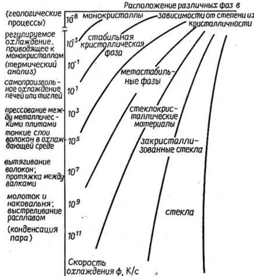
**Требуется:** отсутствие взаимодействия, быстрая теплопередача/теплоперенос, большая теплоемкость. Жидкий азот – изолирующая газовая «подушка», сплав Вуда, In/Ga эвтектика, Hg - быстрая закалка.
