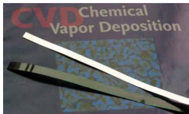
Внешний вид подложки RABiTS и ленты с нанесенными буферным и сверхпроводящим слоями
