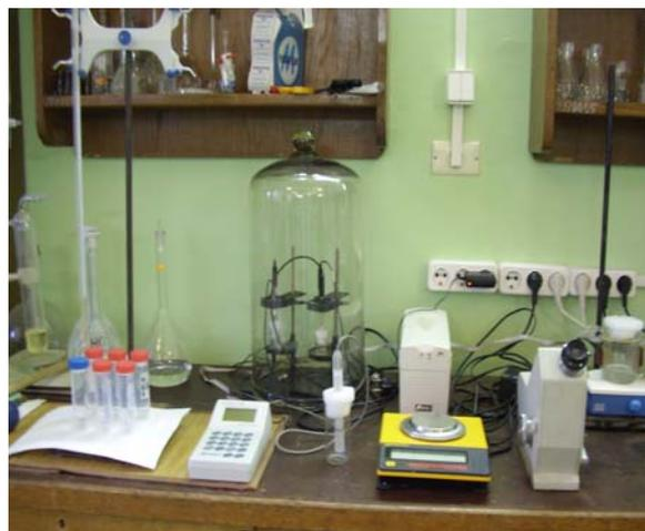
Измерения электропроводности – один из способов определения среднеионных коэффициентов активности электролитов в водных растворах
