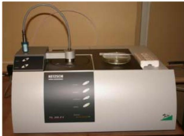
Прибор предназначен для измерения величины потери массы образцом в различной газовой атмосфере при термическом воздействии
