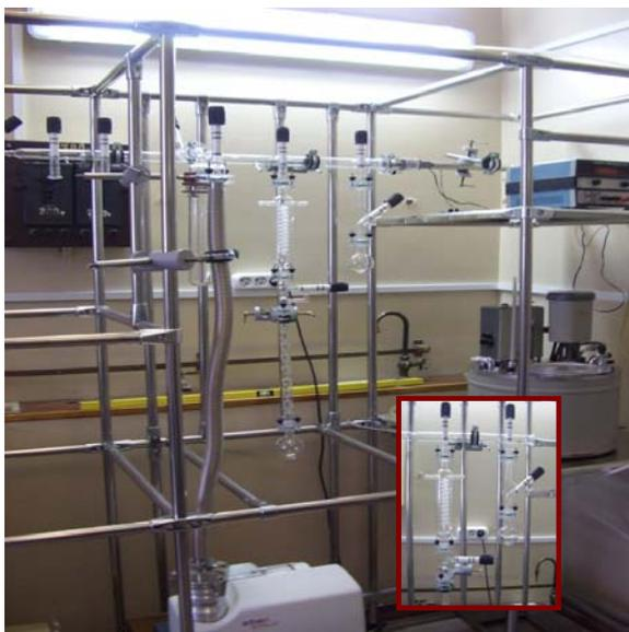
Установка для измерения давления пара статическим методом. С помощью данного метода можно определять активности летучих компонентов систем в интервале температур от 15 до 35 С
