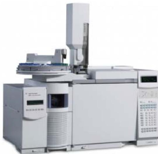
Прибор предназначен для качественного и количественного анализа выделенных газов в квазинепрерывном режиме времени с возможностью работы в режиме накопления, в режиме анализа по возникновению изменений массы анализируемого образца
