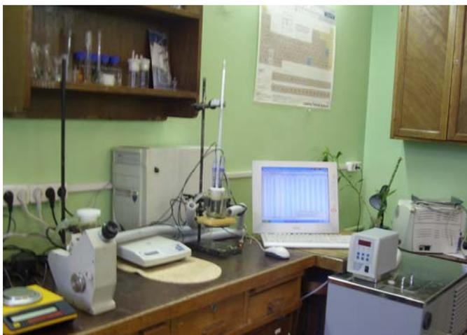
Потенциометрический метод определения среднеионных коэффициентов активности электролитов в водных и водно-органических системах
