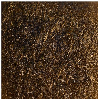
PRAI 21. V3 ( $\text{Co}_3\text{O}_4$ -0.35% +  $\text{MnO}_2$ -0.4% + каолин-5% + оптапикс).
