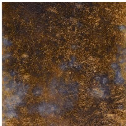
РА 24. На ангобе V3 ( $\text{Co}_3\text{O}_4$ -0.35% +  $\text{MnO}_2$ -0.4% + каолин-5% + оптапикс).
