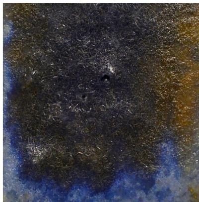
PA 11. На ангобе V3 ( $\text{Co}_3\text{O}_4$ -0.35% +  $\text{MnO}_2$ -0.4% + каолин-5% + оптапикс).
