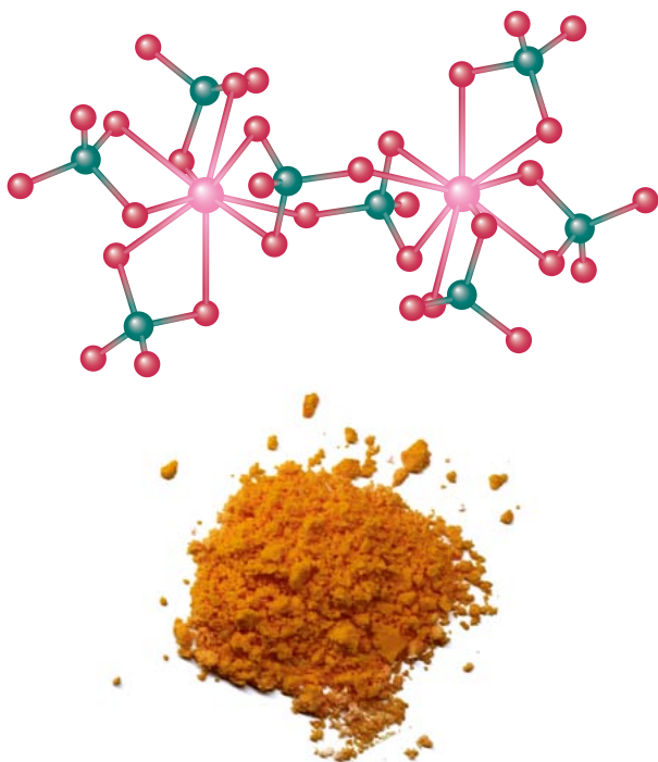
Рис. 6. Структура и порошок (\text{NH}_4)_2[\text{Ce}_2(\text{SO}_4)_6] \cdot 4\text{H}_2\text{O}
