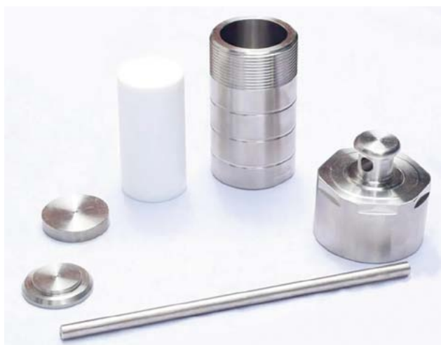
Рис. 1. Типичный реактор для гидротермального синтеза
