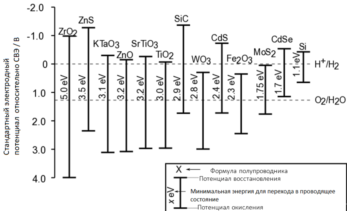
Рис. 2 – Энергии перехода в проводящее состояние и электродные потенциалы различных полупроводников. Пунктирными линиями обозначены потенциалы окисления и восстановления воды. СВЭ = Стандартный водородный электрод.
