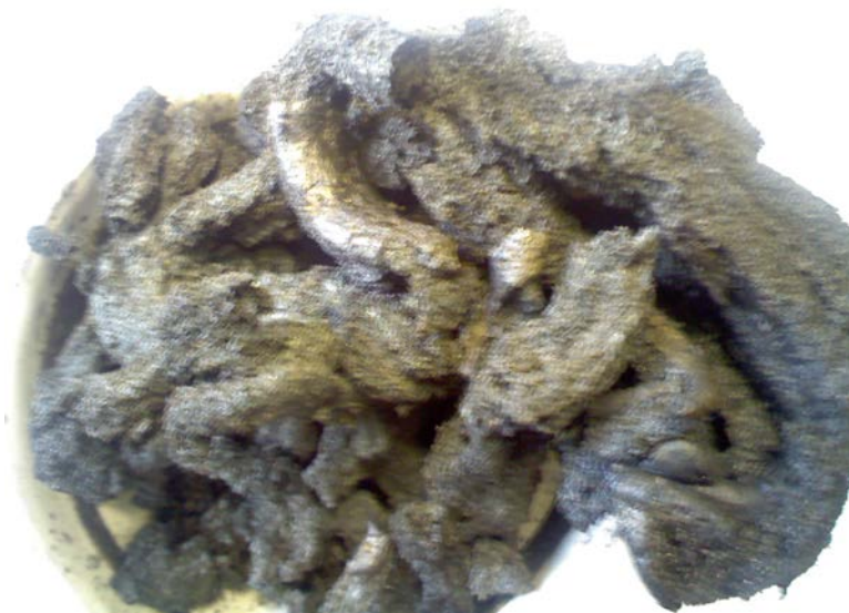
Рисунок 3 – Фотография образца SYCM, полученного с использованием полиакриламидного метода синтеза, после разложения геля на воздухе при 400^\circ\text{C} .
