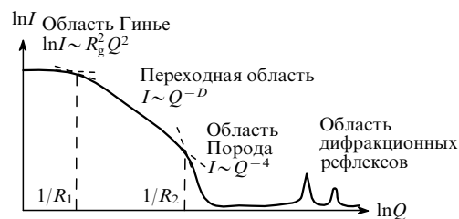
Рис. 20. Общий вид кривой малоуглового рассеяния на неоднородном объекте.
