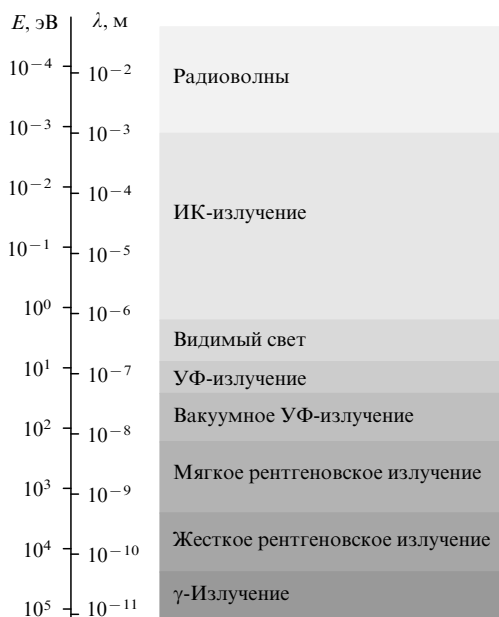
Рис. 2. Спектральные диапазоны электромагнитного излучения, получаемого в синхротронных центрах.
