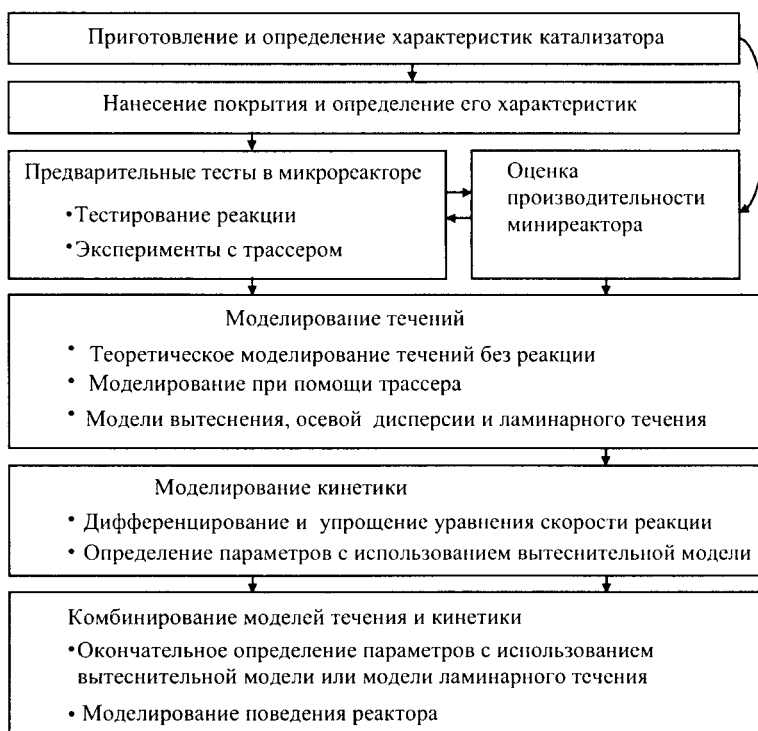
Рис. 16. Предложенный подход к изучению кинетики в газофазных микрореакторах
