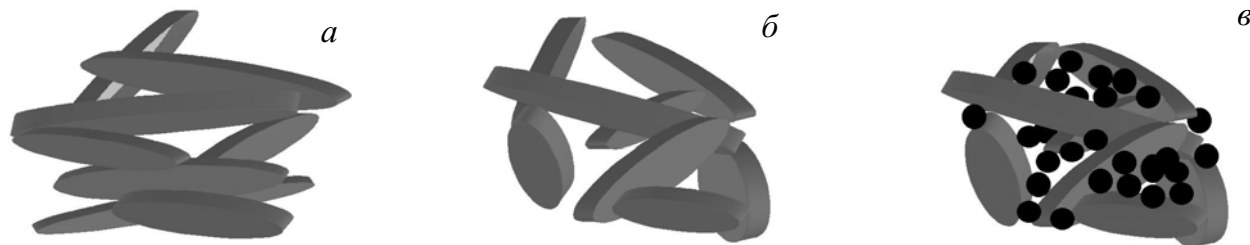
Рис. 5. Упаковка частиц анизотрического наполнителя при разных способах прессования:
