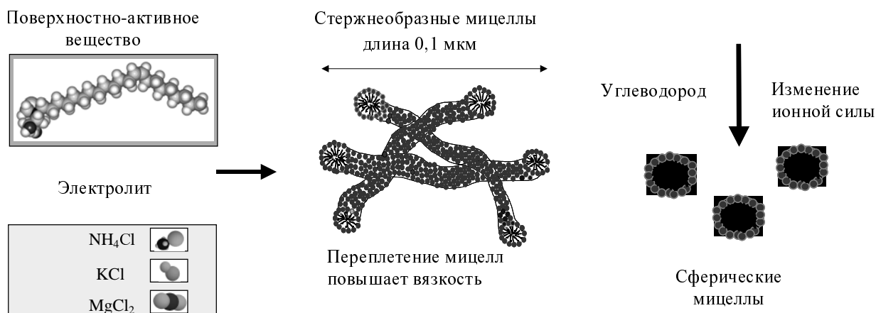
Рис. 6. Принцип действия вязкоупругой поверхностно-активной жидкости для гидравлического разрыва [35]
