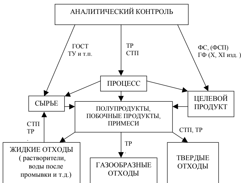
Рис.2. Общая схема аналитического контроля производства синтетических лекарственных средств [4].
