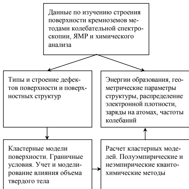
Рис. 1. Схема формирования и расчета кластерных моделей поверхности
