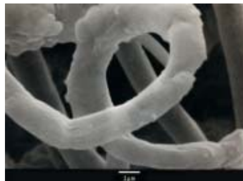
Рис. 8. Нитеобразные частицы \alpha\text{-Fe} в полых макрочастицах железа
