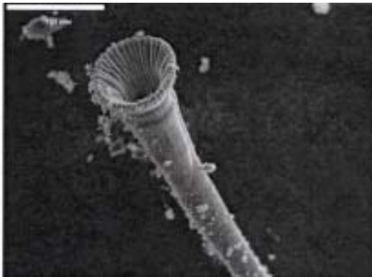
Рис. 9. Полые макротрубки из слабо закристаллизованного оксида алюминия
