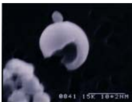
Рис. 4. Полые частицы гидразона гидразида о -нитробензойной кислоты и формальдегида
