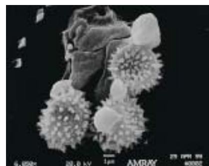
Рис. 6. Полые частицы гидроксонитрата кобальта, инкрустированные микрокристаллами нитрата аммония
