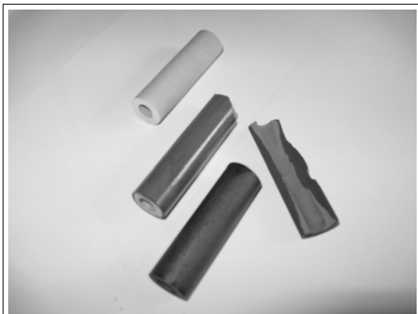
Рис. 1б. Карбонизованная мембрана на разных этапах получения (исходная подложка, после термостабилизации, после карбонизации) и скол карбонизованной мембраны
